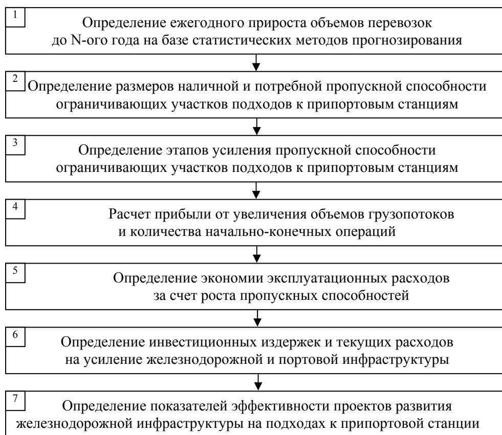
Рис. 2. - Алгоритм реализации мероприятий, направленных на обеспечение соответствия пропускной способности транспортной инфраструктуры перспективам роста объема перевозок
