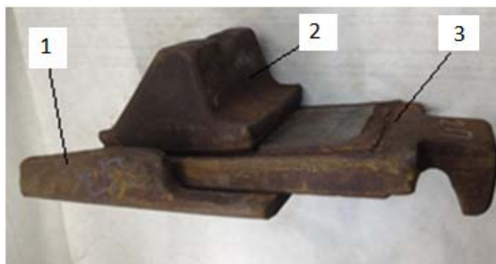
Рис. 2. – Фрикционный узел поглощающего аппарата ПМКП
