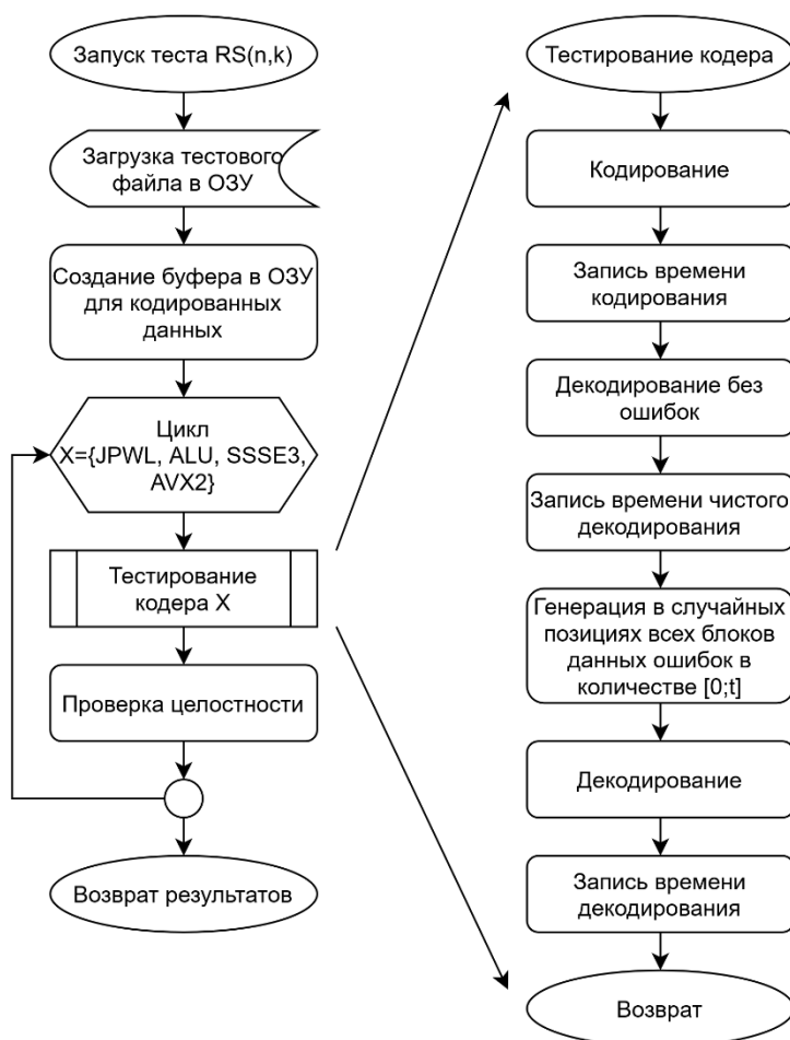
Рис. 1. – Схема работы исследовательского программного комплекса
