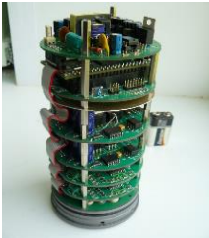
Рис. 1. – Внешний вид малогабаритного многофункционального гидролокационного комплекса для подводного буксируемого аппарата
