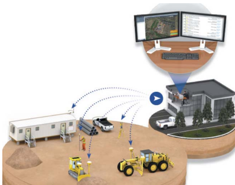
Рис. 1. Построение системы дистанционного управления и контроль за проведением землеройно-планировочных работ
