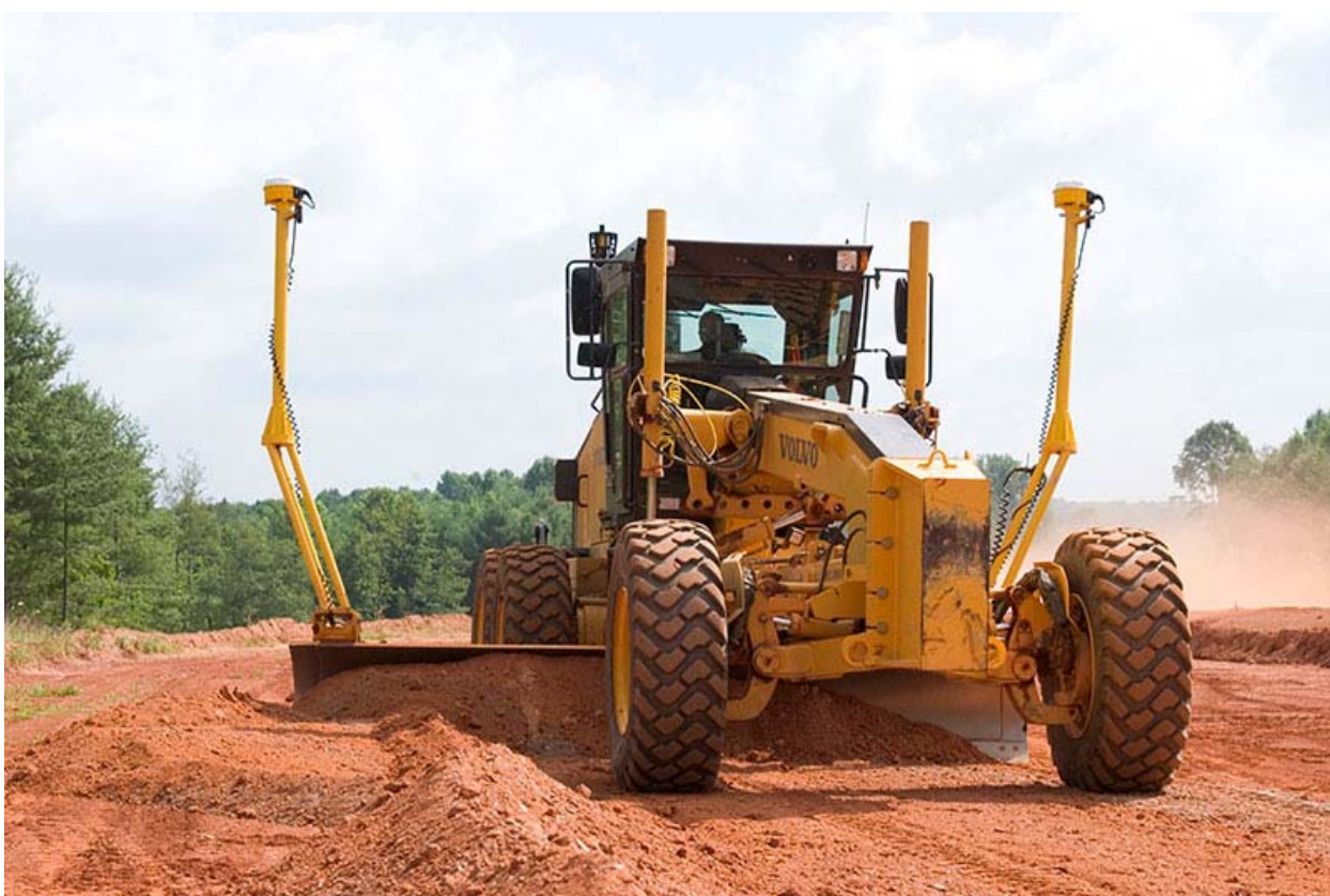
Рис. 2. Работа автогрейдера с системой распознавания образов
