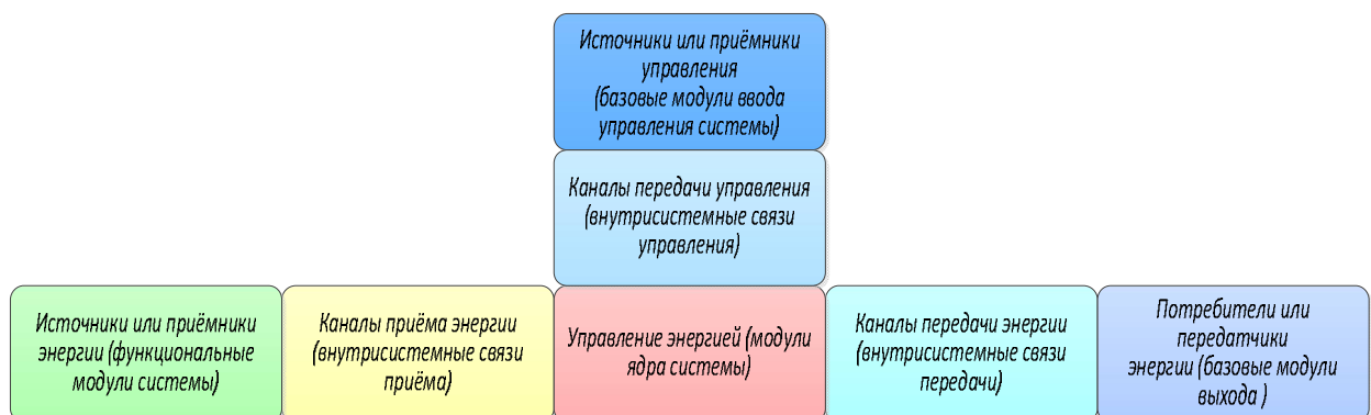
Рис. 2. – Основной состав энергетической МФМС
