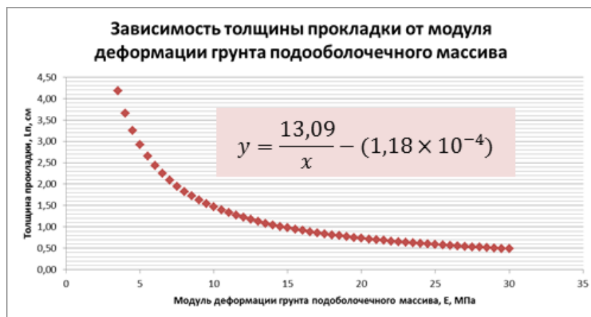
Рис. 7. – График зависимости толщины прокладки от модуля деформации грунта подошвенного массива. 2-й вариант
