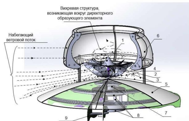
б) принцип действия ВЭУ вихревого типа
