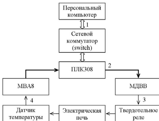
Рис. 3. – Экспериментальная установка для исследования цифровых алгоритмов идентификации и управления
