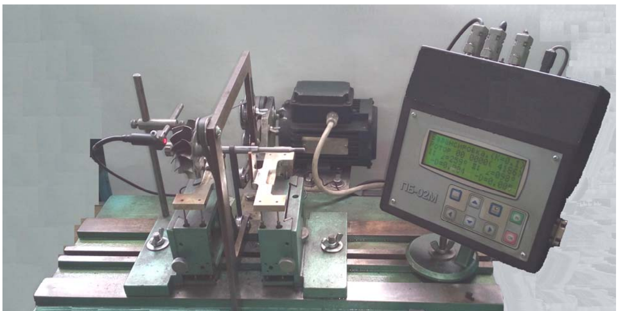
Рис. 1. – Станок для балансировки роторов БВИ-03-09Т с прибором ПБ-02М
