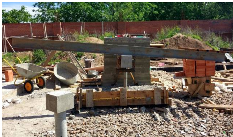
Рис. 3 – Вид стенда для испытаний с установленным на образец рычагом
