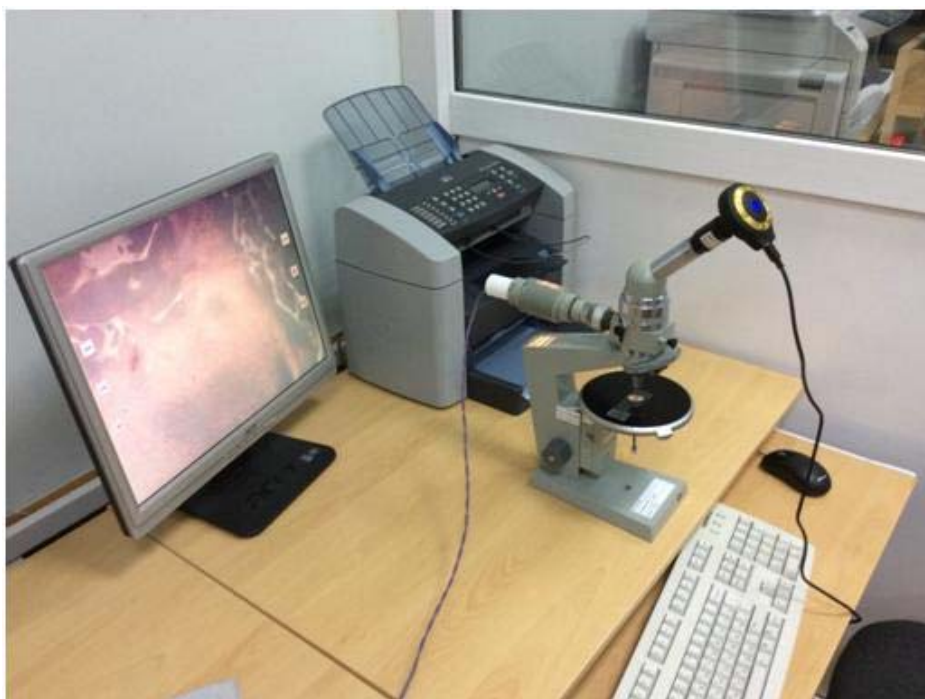
Рис.1. – Микроскоп с цифровым видеоокуляром DCM-310
