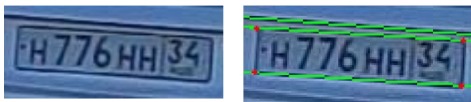
Рис. 3. – Область пластины номерного знака с обнаруженными линиями.
