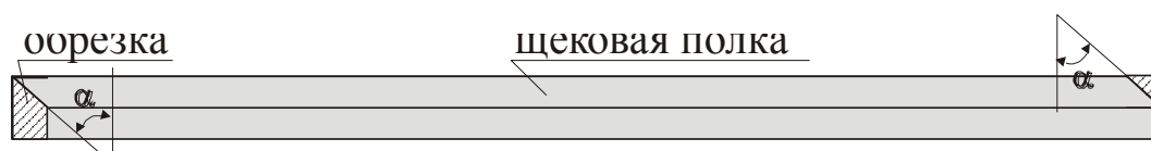
Рис. 6. Компоновка штампа примыкания раскоса углового профиля
