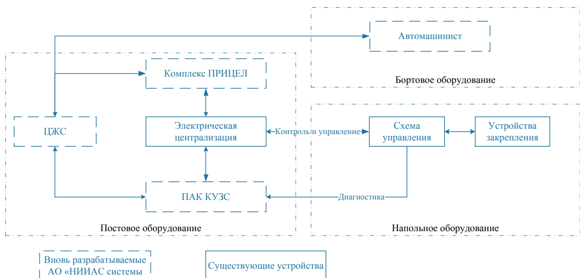
Рисунок 2. – Схема автоматического закрепления подвижного состава
