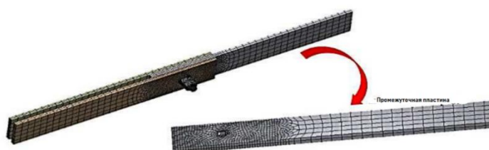
Рис. 2. - Детальная модель из конечных элементов: механического узла
