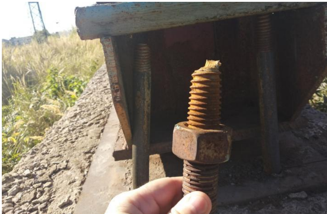
Рис.3. Сломанная, вследствие удара, шпилька
