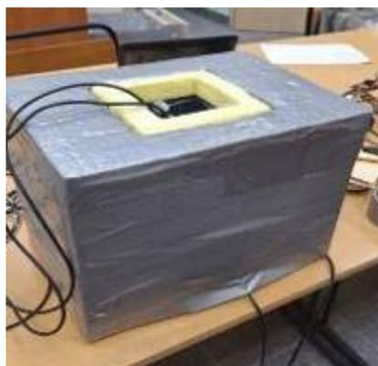
Рис.2. – Установка для исследования теплопроводности материала.
