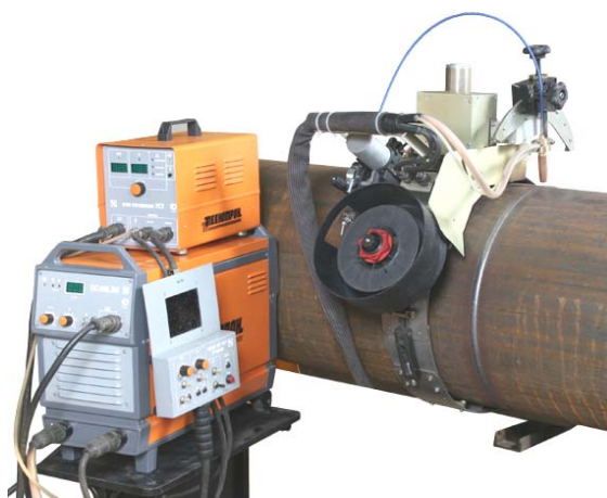
Рис. 3. – Установка для орбитальной сварки кольцевых стыков труб большого диаметра
