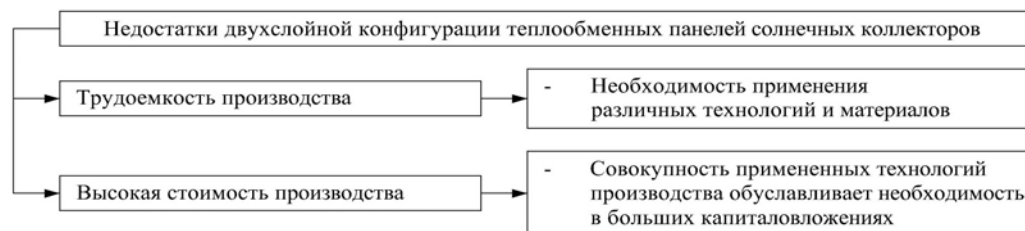
Рис. 2 – Недостатки двухслойных теплообменных панелей
