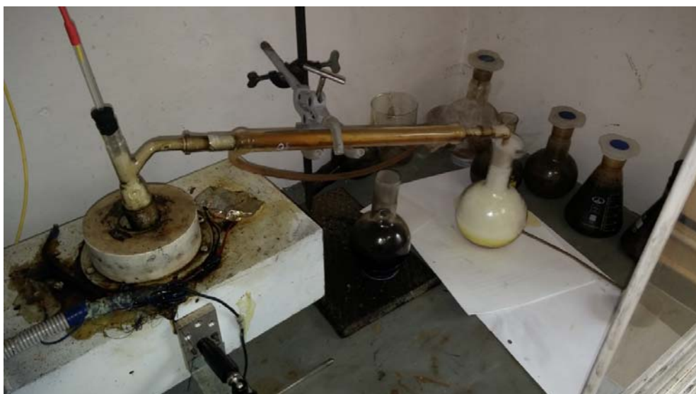
Рис.4. Процесс переработки нефтешлама с использованием дизельного топлива
