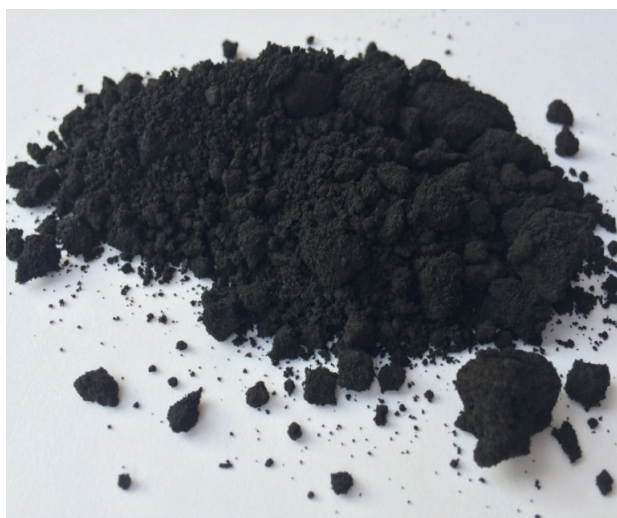
Рис.2. Исходный нефтешлам использованный в экспериментах.
