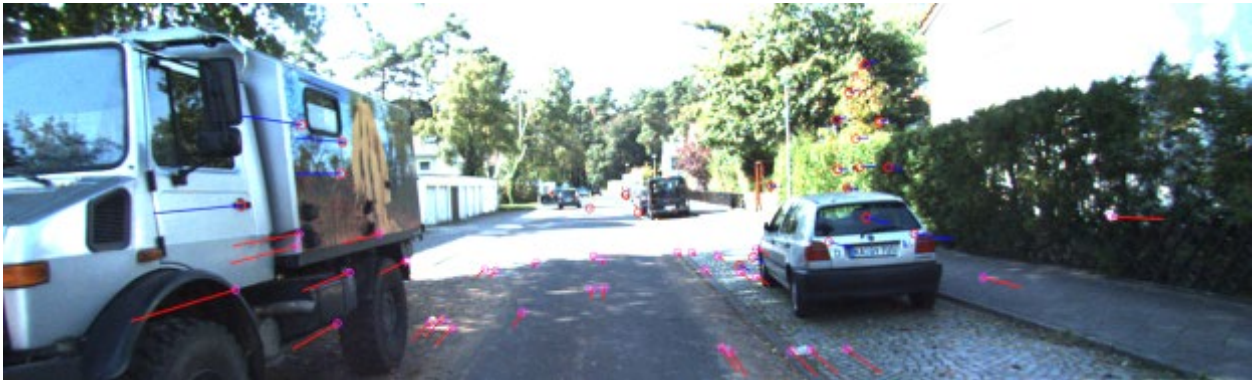
Рис. 1. Отслеживание точек на нестандартной дороге с большим количеством статических объектов. Синяя линия – оптический поток точек SIFT, красная линия – оптический поток точек Shi-Tomasi
