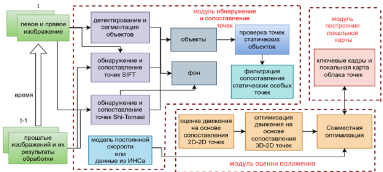
Рис. 2. Архитектура предлагаемой системы РВИО
