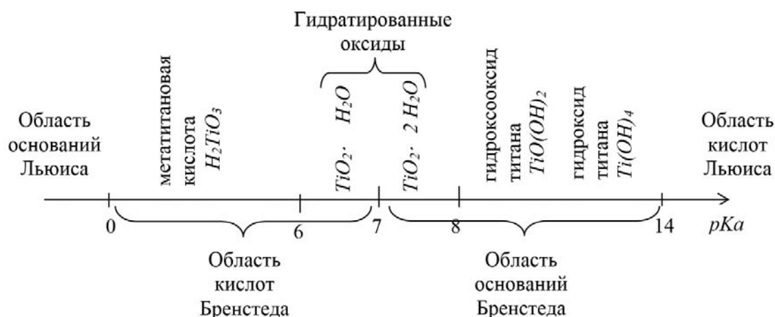
Рис.2. – Формы кислотно-основных центров на поверхности TiO_2 \cdot nH_2O
